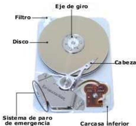
Las unidades de los discos duros contienen 2 o más discos (platos) apilados sobre un eje central y aislados completamente del exterior. Los elementos móviles que poseen están mucho mejor contruidos. El sistema gira rápidamente y los discos son de mayor densidad. Esto hace que la capacidad de los discos duros sea mucho mayor que la de los discos flexibles.
