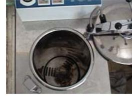
**ESTERILIZACION POR CALOR SECO:** Se usa para los elementos de vidrio, y otros materiales que resisten la penetración del vapor.
