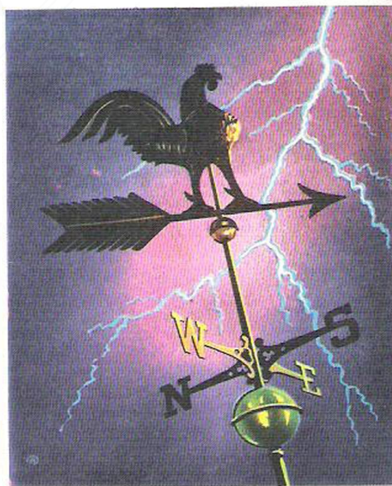
FIG. 137. La veleta es el instrumento más sencillo para conocer la dirección en la cual sopla el viento.
