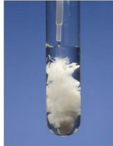
Formación del precipitado de  $\text{BaSO}_4$ .
