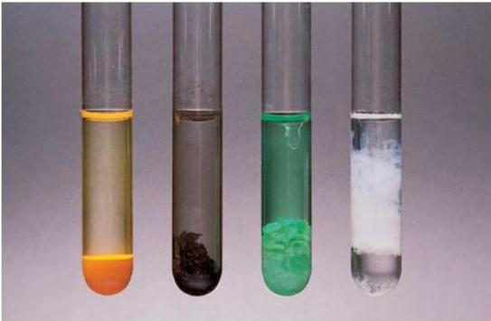
Aparición de algunos precipitados. De izquierda a derecha:  $\text{CdS}$ ,  $\text{PbS}$ ,  $\text{Ni}(\text{OH})_2$  y  $\text{Al}(\text{OH})_3$ .
