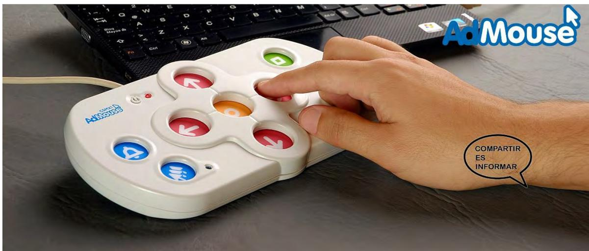
Las funciones y sencillez de uso de Admouse permiten al usuario emular los comandos de un ratón convencional de manera intuitiva. Tiene conexión USB y no requiere la instalación de ningún software específico (tecnología Plug and Play). Todas sus teclas presentan un relieve especialmente diseñado para evitar pulsaciones involuntarias.
