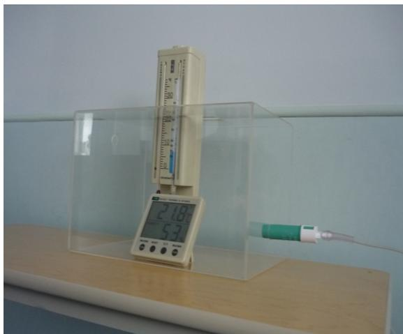
**Figura 1.** Cámara de acrílico con higrómetro análogo y digital instalados. También se observa inyector de oxigenoterapia y manguera de conexión a humidificador y/o flujómetro.
