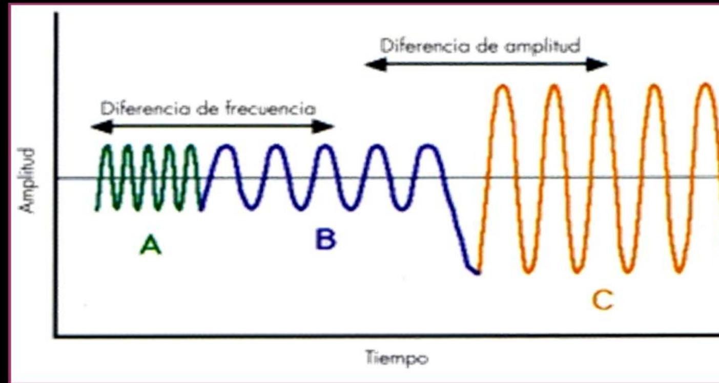
*Las bases físicas de la sonografía es a través de las variaciones de la amplitud o de la frecuencia del eco recogido. En A y B se tiene las mismas amplitudes y distintas frecuencias, a su vez B con C tienen distinta amplitud con igual frecuencia*
