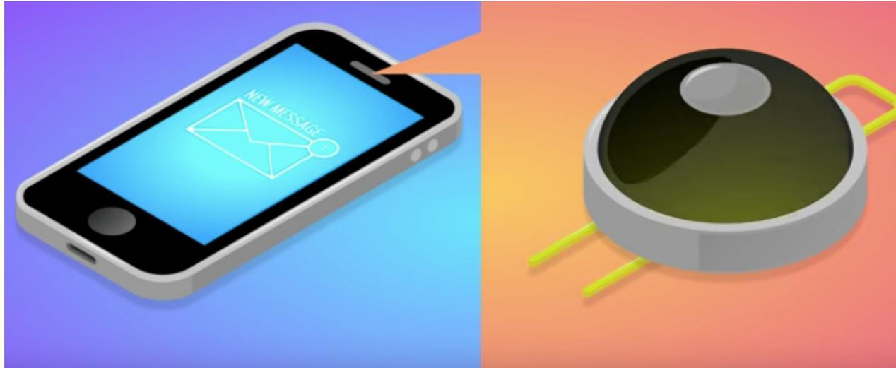
Si escuchamos el celular, es porque tiene un parlante, que consiste en un diafragma y un soporte fijo. Las vibraciones del diafragma se transmiten a las moléculas de aire alrededor, las cuales son detectadas en el oído!
