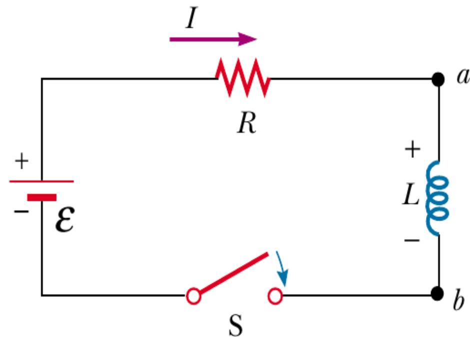
Si el interruptor se cierra en  $t=0$ , la corriente empieza a crecer, y el inductor produce una fem inversa, que se opone al incremento de la corriente. En otras palabras, el inductor actúa similar a una batería cuya polaridad es opuesta a la de la batería real en el circuito. La fem inversa es:
