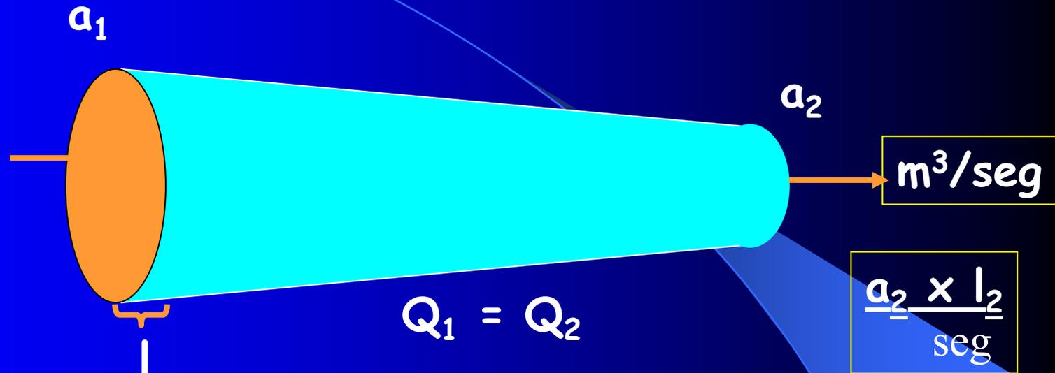
$$\text{área}_1 \times \text{velocidad}_1 = \text{área}_2 \times \text{velocidad}_2$$
