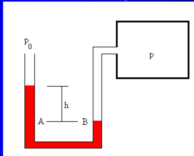
Para medir la presión empleamos un dispositivo denominado **manómetro**. Como **A** y **B** están a la misma altura la presión en **A** y en **B** debe ser la misma. La presión en **B** es debida al gas encerrado en el recipiente. Por la otra parte la presión en **A** es debida a la presión atmosférica más la presión debida a la diferencia de alturas del líquido manométrico.
