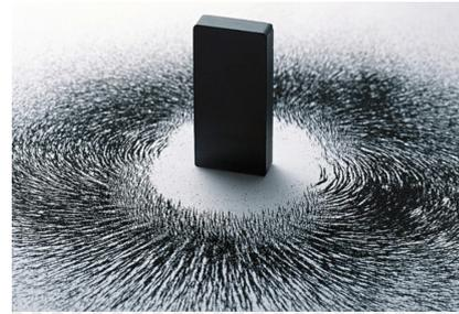
Figure 7.2: Limadura de hierro en un campo magnético.
