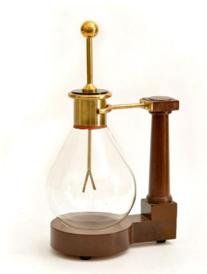
Figure 1.2: Electroscopio de panes de oro o pozo de Faraday.
