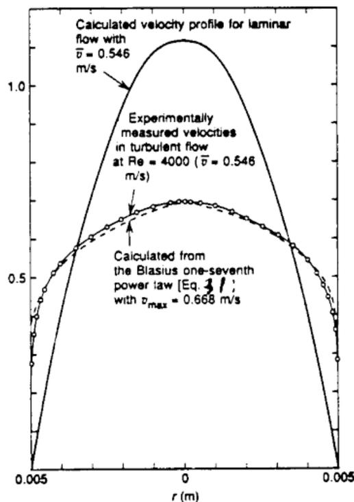
Para flujo turbulento ( $Re_X > 4000$ ) se puede usar la ecuación semi-empírica de Blasius para calcular el perfil de velocidad.
