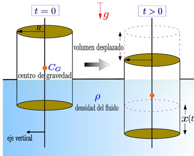
*Ind:* Considere que el eje del cilindro se mantiene vertical, denote además como CG al centro de gravedad del objeto y tenga en cuenta el *principio de Arquímedes*: “Un cuerpo al ser sumergido parcial o totalmente en un fluido experimenta un empuje hacia arriba igual al del peso del fluido que desplaza.”
