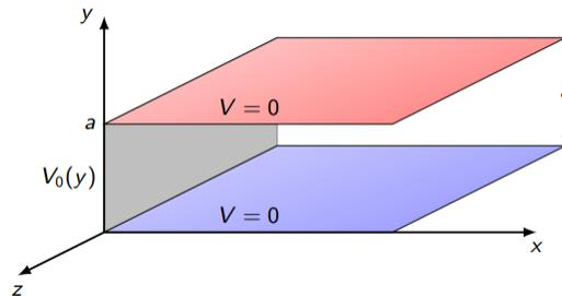
Figura 1: Configuración similar a capacitor, dos placas de metal paralelas al plano  $xz$ , una en  $y = 0$  y otra en  $y = a$ . En  $x = 0$  las placas están conectadas y cerradas con una tira infinita y aislada de las dos placas la cual mantiene un potencial específico  $V_0(y)$ .
