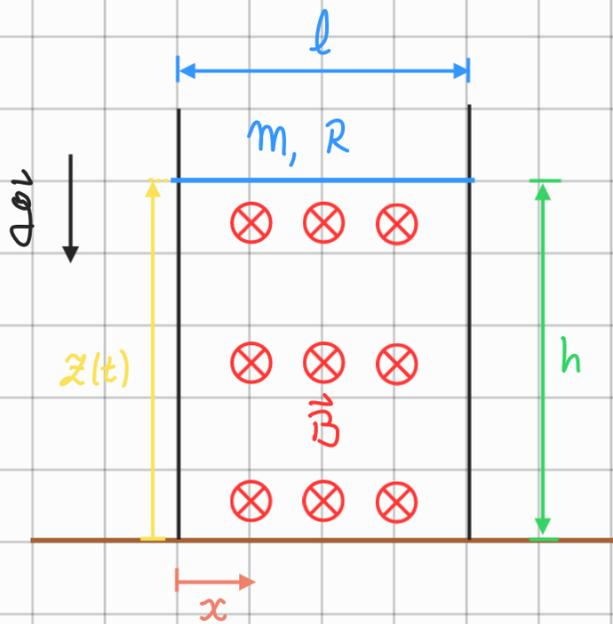
Las barras verticales, la barra horizontal y la tierra forman un circuito. Al caer la barra azul, cambia el flujo de  $\mathbf{B}$  a través del circuito, lo que induce una fem (voltaje), y por tanto, aparece una corriente que al estar en presencia del campo  $\mathbf{B}$  sufrirá fuerza de Lorentz.
