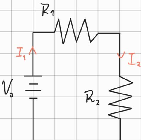
De aquí se puede ver que la resistencia equivalente del circuito es  $R_1 + R_2$ , y aplicando la Ley de Ohm se llega a
