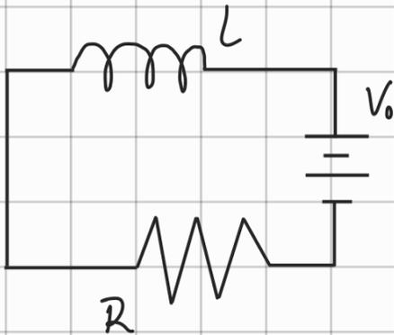
$$I(t) = \frac{V_0}{R} (1 - e^{-\frac{Rt}{L}}) + I_0 e^{-\frac{Rt}{L}}$$
