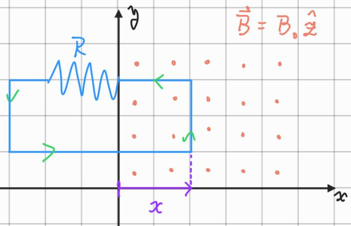
Usamos la variable  $x$  para describir la distancia que la parte delantera del carro ha penetrado en la zona de campo magnético. Por otro lado, orientamos el circuito en sentido anti-horario (flechas verdes), de modo que la normal a su superficie apunta en  $\hat{z}$ .
