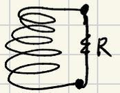
Con el valor de el voltaje presente en el circuito y el de la resistencia equivalente de este obtenemos la corriente que circula por ley de ohm.
