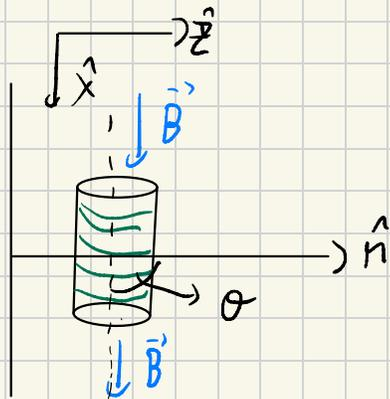
En la condicion inicial donde la bobina esta paralela a la placa el flujo magnetico sera la suma del flujo magnetico de cada espira de la placa. A medida que el angulo vaya variando el flujo magnetico disminuira debido a que el area efectiva que esta siendo atravesada por B es menor al estar en diagonal. Esta dependencia angular se modela con la funcion trigonometrica que alcanza su maximo en 90 grados, el seno.
