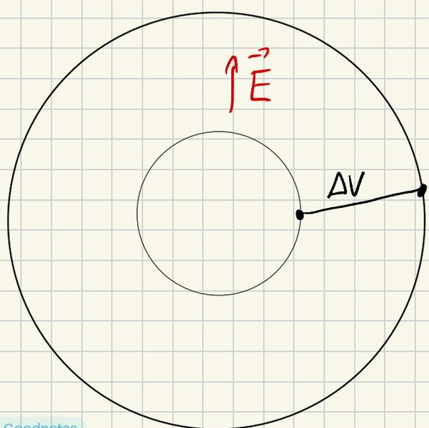
Si existe una diferencia de potencial es porque hay un campo  $E$  entre las placas, que por geometria podemos decir que es radial. Si es para adentro o para afuera no nos interesa para calcular la resistencia pues se calcula usando las magnitudes de  $I$  y  $V$ .
