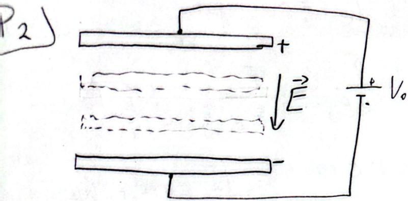
Si entre las placas externas existe un potencial de  $V_0$ , al hacer la integral de línea  $\int_+ \vec{E} \cdot d\vec{l}$  para cualquier trayectoria obtendremos  $V_0$
