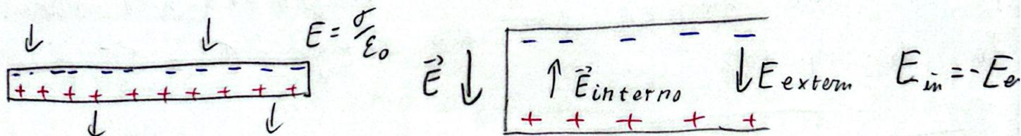
Debido al campo producido por las placas externas las cargas positivas se irán a una cara y las negativas a otra. Esta configuración creará un campo interno que contrarreste al  $E_{\text{ext}}$ .
