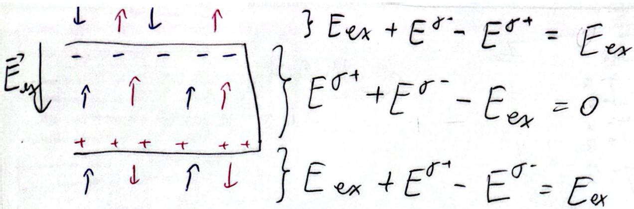
Sin embargo fuera de la placa el campo interno provocado por las cargas de la placa desaparece. Las placas centrales no afectan al campo fuera de ellas
