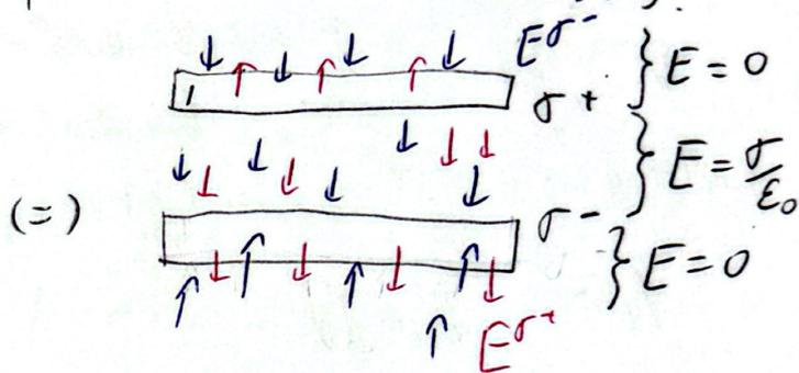
Con esta configuración en donde las caras externas de las placas externas tienen  $\sigma=0$  y las caras internas  $\sigma^+$  o  $\sigma^-$ , el campo dentro de las placas conductoras es nulo.
