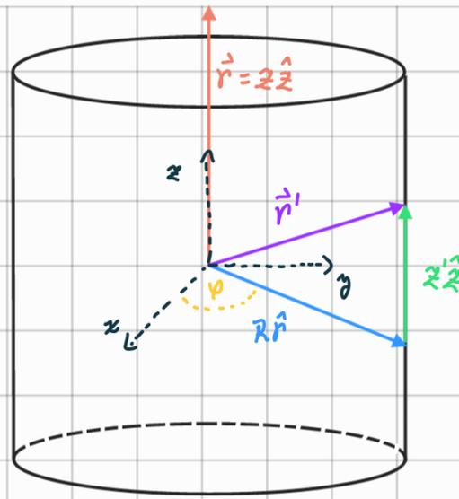
Ahora nos falta el diferencial de carga  $dq$ , recordemos que esto es solo un pedacito muy chico de carga. Como tenemos que nuestro cilindro tiene densidad de carga **superficial**  $\sigma$ , un pedacito de carga  $dq$  será igual a la densidad de carga por un pedacito de área  $dA$ , es decir  $dq = \sigma dA$ .
