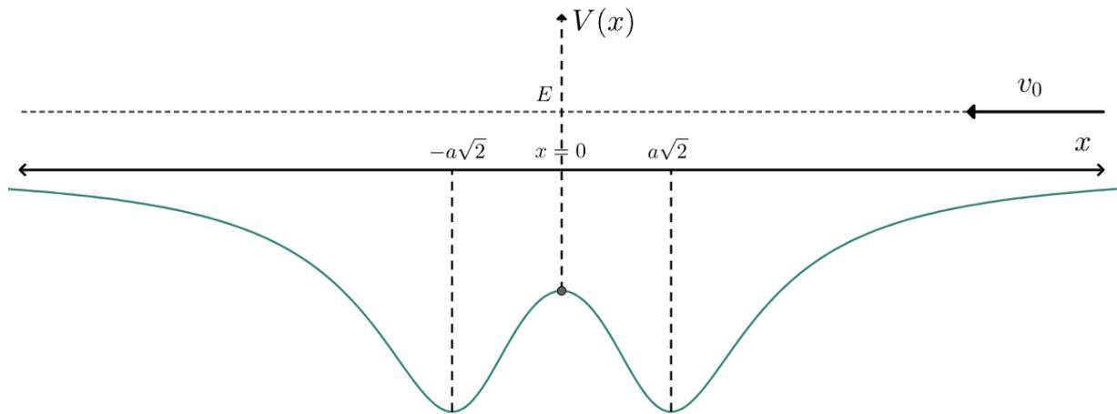
Suponga que la partícula parte desde  $+\infty$  y se desplaza hacia el origen con una velocidad inicial  $-v_0\hat{x}$  ( $v_0 > 0$ ). Al pasar por la posición  $x = a$  sufre una colisión con otra partícula, durante la cual pierde una fracción  $\alpha$  ( $0 \leq \alpha \leq 1$ ) de la energía cinética que llevaba **justo antes** de la colisión.
