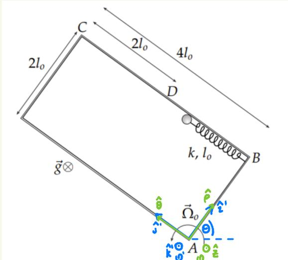
$$m \vec{r}'' = \vec{F} - m \vec{R} - m \vec{\Omega} \times (\vec{\Omega} \times \vec{r}') - 2m \vec{\Omega} \times \vec{r}' - m \vec{\Omega} \times \vec{r}'$$
