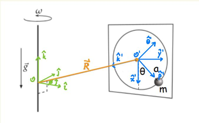
$$m \vec{r}'' = \vec{F} - m \vec{R} - m \vec{\Omega} \times (\vec{\Omega} \times \vec{r}') - 2m \vec{\Omega} \times \vec{r}' - m \vec{\Omega} \times \vec{r}'$$
