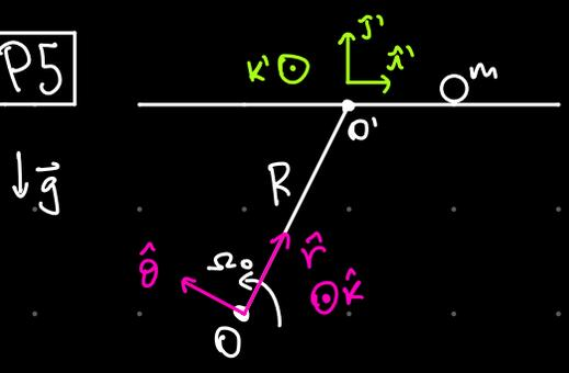
a) Definimos un sist. no inercial con origen en  $O'$ , que acompaña la plataforma. Los ejes no giran pues  $x', y'$  apuntan en la misma dirección. ( $\dot{\omega}_z = 0$ )
