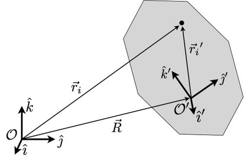
Figura 1: Sistema de Referencia No Inercial
