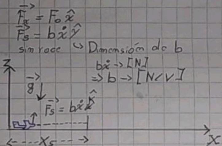
Como el avión se mantiene pegado al suelo durante su despegue, las componentes  $y = cte \Rightarrow \dot{y} = \ddot{y} = 0$
