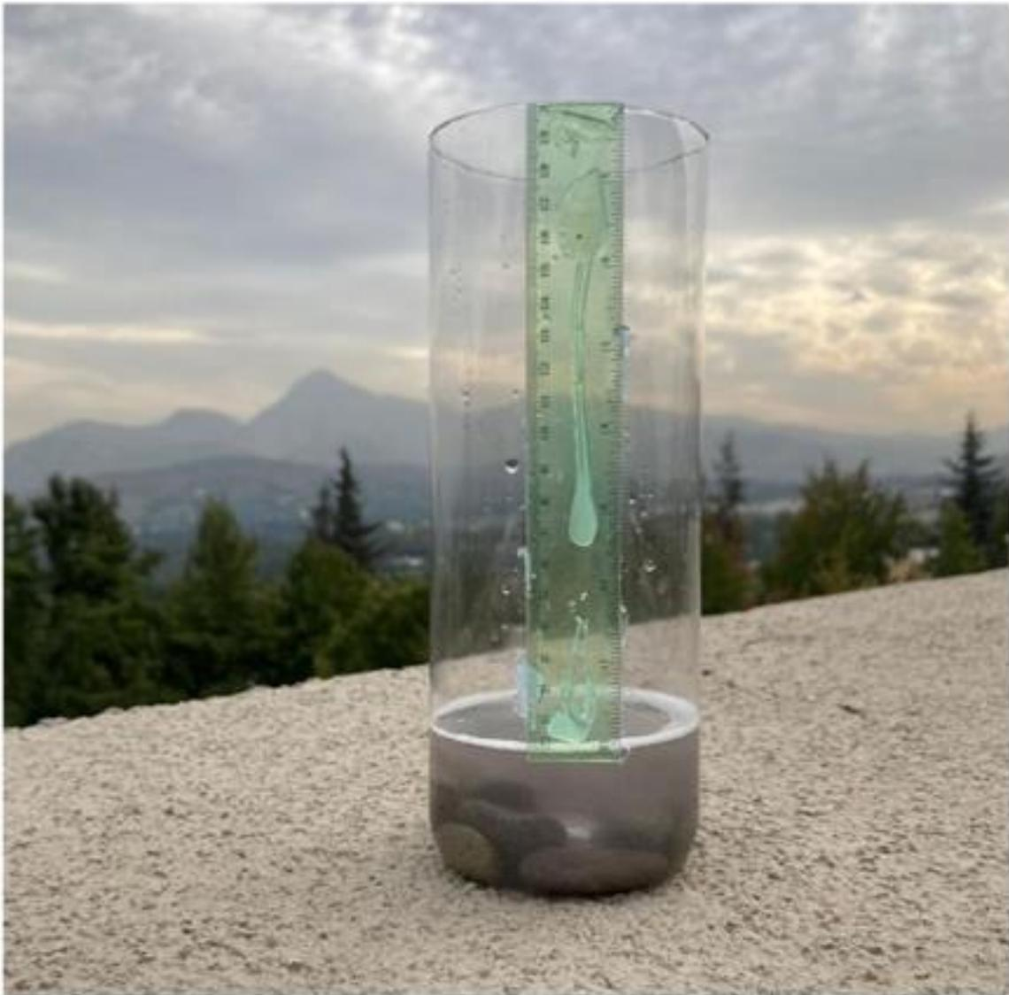
Pluviómetro artesanal construido con una botella de agua mineral de 3 litros. Lo más importante de asegurar es que la sección transversal del recipiente sea la misma desde el borde superior hasta el nivel de referencia. Se le puede agregar un colorante al agua para facilitar la medición. Se recomienda agregar arena o piedras en la base de recipiente por debajo del nivel de referencia, para evitar el volcamiento por el viento.
