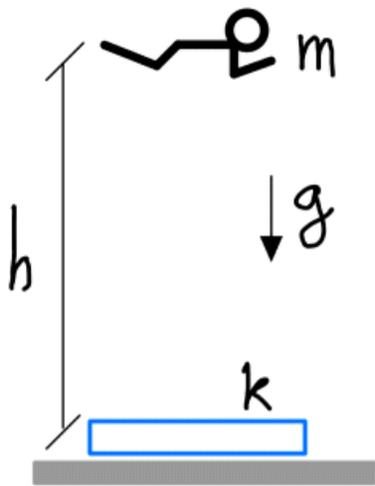
(a) Calcule su velocidad justo antes de tocar el colchón. Recuerde que la Energía cinética es  $K = \frac{1}{2}mv^2$ . Puede considerar que el trabajo del peso entre una altura  $y_0$  y una  $y$  es  $W_{-mg}^{y_0 \rightarrow y} = -mg(y - y_0)$ , o que el potencial gravitatorio a una altura  $y$  es  $V(y) = mgy$ .
