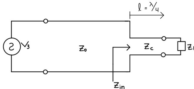
Figura 2: Línea de transmisión con adaptador  $\lambda/4$
