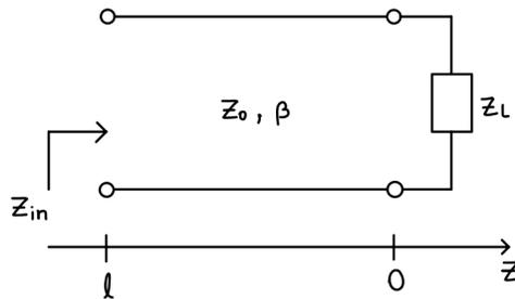
Figura 1: Esquema de la línea de transmisión con carga  $Z_L$
