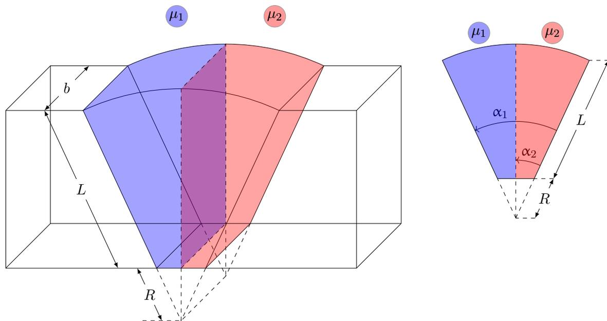
Figura 3: Esquema pregunta 3. El bosquejo de la derecha está compuesto de dos materiales (destacado con azul y rojo). La sección de la izquierda muestra el material en tres dimensiones, y la derecha muestra la distribución angular del corte.
