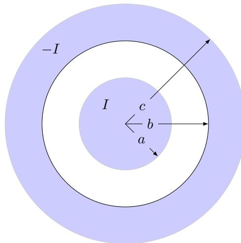
Figura 3: Estructura coaxial de la pregunta 3.
