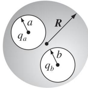
Figura 2: Esfera conductora con cavidades.
