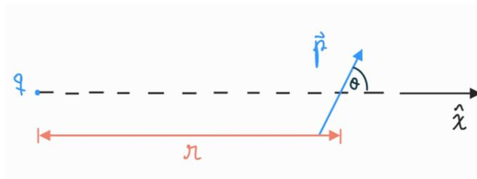
Figura 4: Carga puntual y dipolo.
