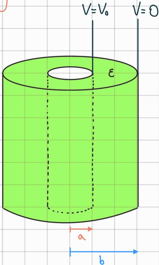
Para la parte interior ( $r < a$ ) podemos resolver mediante la Ley de Gauss. Se puede notar de inmediato que en dicha zona la carga encerrada sera igual a 0, pues se tiene un vacío.
