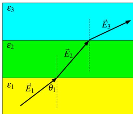
Figura 3: Láminas dieléctricas apiladas.
