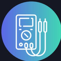
Si tu circuito está fallando, utiliza el multímetro para medir conectividad. Selecciona en el multímetro el ícono de arriba y emitirá un sonido si los cables están conectados
