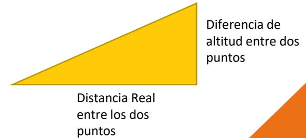
$$\text{Tan}(\alpha) = \frac{\text{Diferencia de altitud entre dos puntos}}{\text{Distancia real entre los dos puntos}}$$
