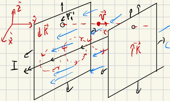
Para sacar el  $\vec{B}$  en los orificios tendremos que sumar los campos de los 3 conductores en ese punto
