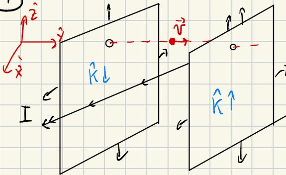
Para calcular el campo en los orificios, calcularemos el campo de cada uno de los conductores.
