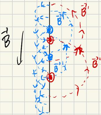
Notemos que en cualquier punto del espacio la componente normal a la placa del  $\vec{B}$  sea nula con la corriente de otra sección de la placa. Con esto concluimos que solo hay campo en  $\hat{y}$
