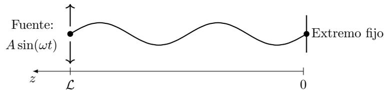
Figura 4: Cuerda forzada con un extremo fijo.
