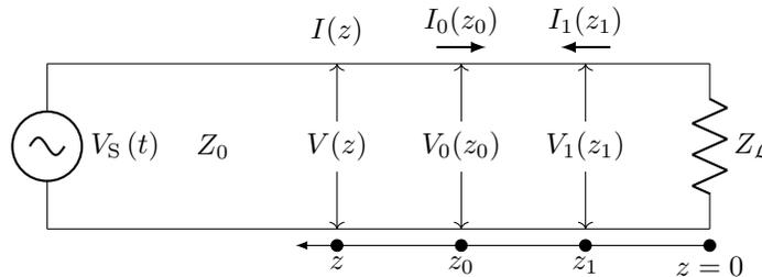
Figura 2: Esquema general de línea de transmisión de pregunta 2. Nótese que la dimensión en  $\hat{\mathbf{z}}$  es  $-\mathcal{L} < z < 0$ .
