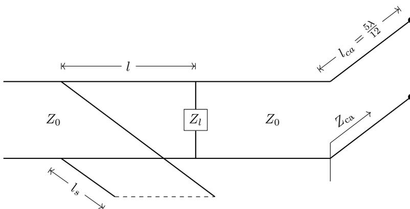
Figura 6: Línea de transmisión en circuito abierto.
