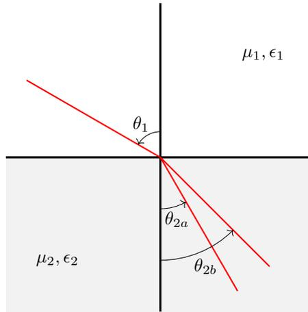
Figura 1: Efecto de birrefringencia de un material altamente anisotrópico. Esto implica que se tendrán dos posibles leyes de Snell:
