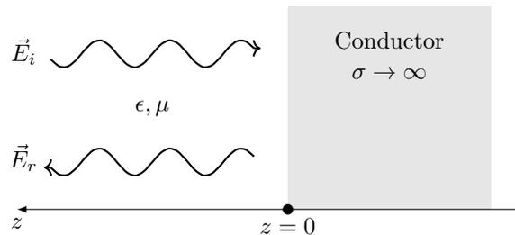
Figura 5: Onda eléctrica y medio conductor.
