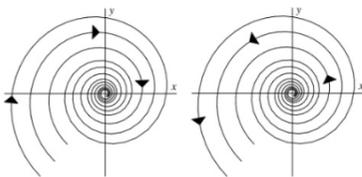
FIGURA 13. Diagrama de fase del sistema (47). A la izquierda  $\alpha < 0, \beta > 0$ , y a la derecha  $\alpha > 0, \beta < 0$ .
