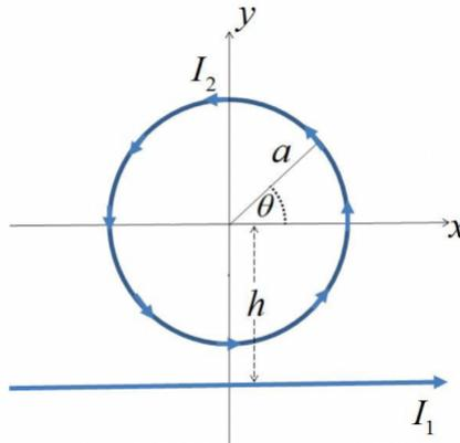
Figura 2: Esquema del alambre infinito y la espira circular.
