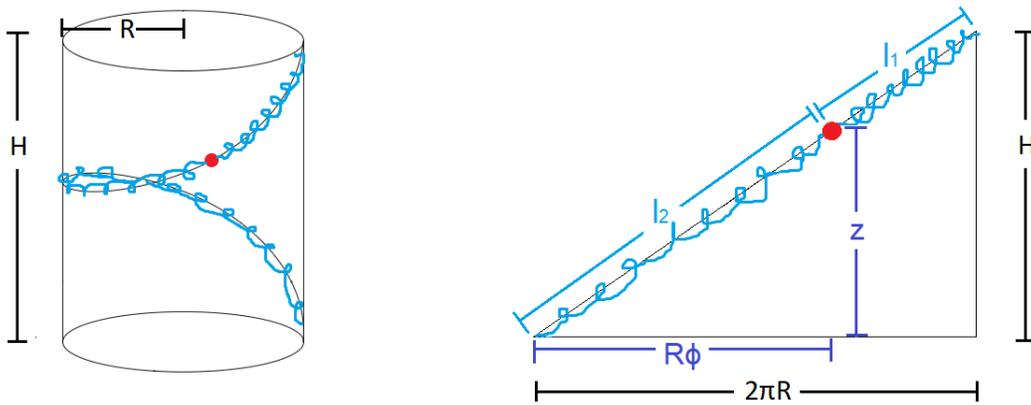
A partir de esta figura podemos notar que, al usar un origen en la base del cilindro, la longitud de cada resorte se puede representar con las coordenadas  $\phi$  y  $z$  usando el teorema de Pitágoras, y entonces:
