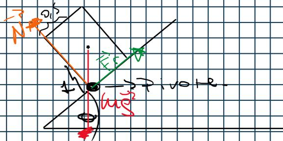
\* En el tipping angle  $\vec{r}$  se refleja completamente en el pivote, dado que se está volcando el bloque.
