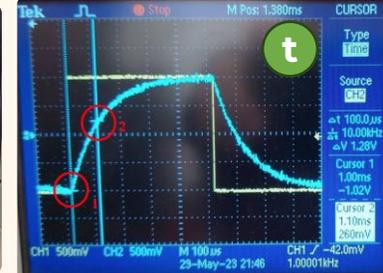
1. Calcular tiempo característico teórico con las magnitudes experimentales de los componentes utilizados, para tener referencia sobre mediciones (recordar que inductancia tiene resistencia interna).
