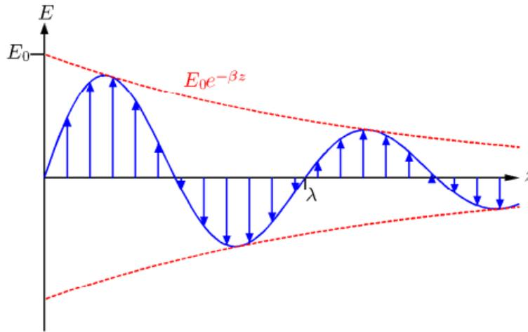
Figura 1: Ilustración del decaimiento del módulo del campo eléctrico a medida que avanza por el eje  $z$ .
