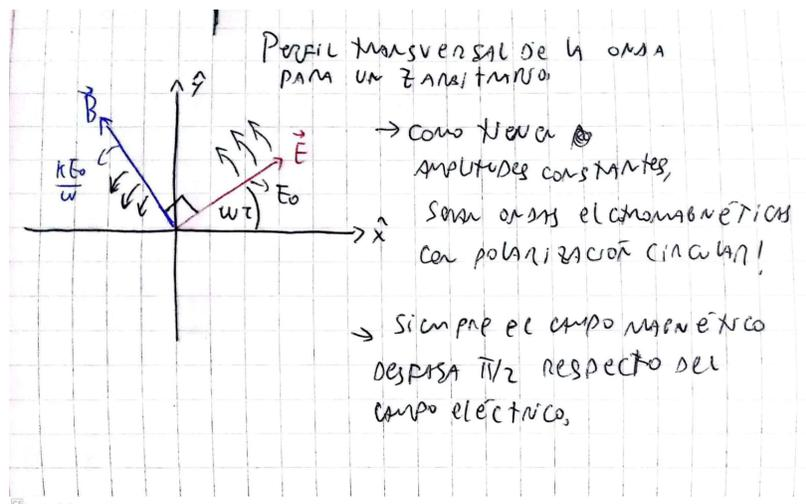
Figura 2: Vista transversal de la onda electromagnética, se observa como los campos están desfasados 90 grados y sus direcciones oscilan en el tiempo según  $\omega$ .
