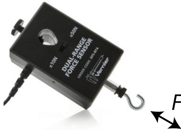
Figura 1.1: Sensor de fuerza marca Vernier, modelo *Dual-Range sensor*. La fuerza puede ser aplicada en ambos sentidos en la dirección del eje que se muestra en la foto.
