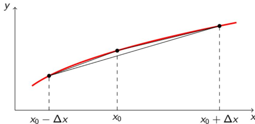
Figura: Estimando la derivada de  $y = f(x)$  en un punto  $P$  usando *forwards*, *backwards* y diferencia centrales.
