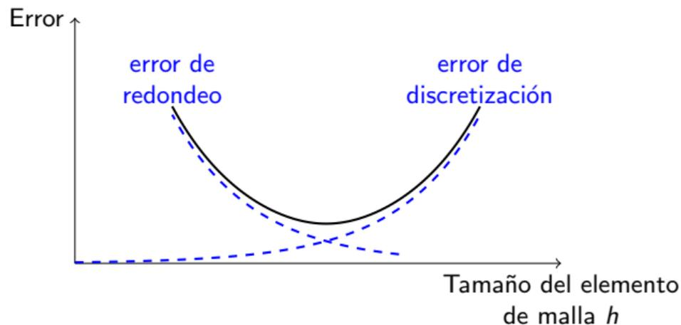
Figura: Error total en función de tamaño de elemento  $h$ .
