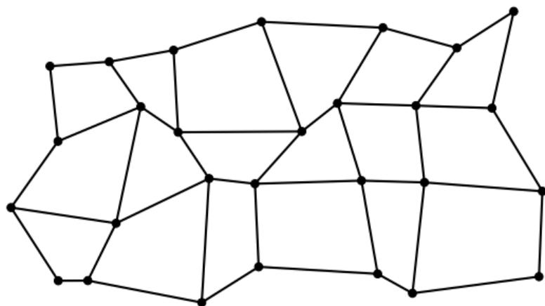
**Figura:** Malla irregular de material. Puntos negros representan los nodos y polígonos de cuatro son llamados elementos. El sistema total es llamado mallado (o *mesh-grid*).
