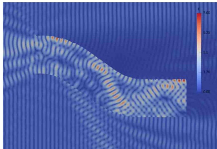
Figura: Simulación de cavidad *cobra* cuando un frente de onda plano choca con este. La solución genera ecuaciones armónicas variables en el tiempo. Escala de color representa  $E$  (freefem++).
