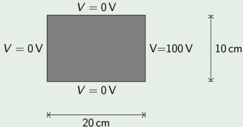
Figura: Geometría rectangular y condiciones de frontera para el potencial eléctrico.
