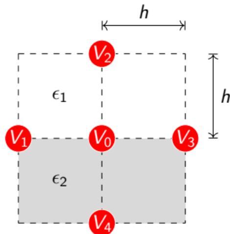
Figura: Cálculo de potencial en cada punto de la malla usando valores de puntos cercanos. Los puntos  $a, b, c, d$  son puntos medios entre los valores conocidos de potencial  $V_i$ , con  $i = 0, 1, 2, 3, 4$ .
