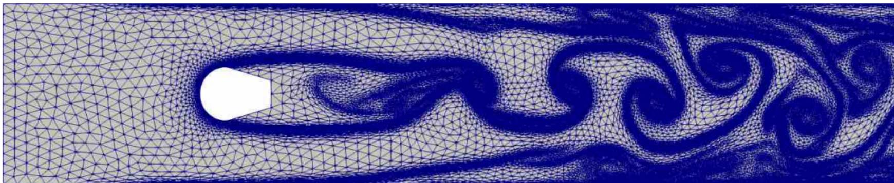
Figura: Ejemplo de malla aplicado en fluidos, donde podemos resolver la Ec.de Navier-Stokes. *Mesh adaptation freefem++*.
