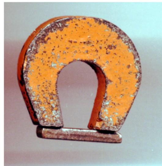
**Figura:** Imán tipo herradura, hecho de Alnico: Al + Ni + Co usados por lo general para hacer imanes permanentes. El descubrimiento de tierras raras suplantó su lugar.
