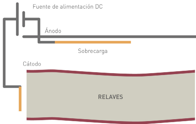
Figura 34. Cubierta electroquímica en un depósito de relaves. Fuente: Modificado de Brousseau et al. , 2000.
