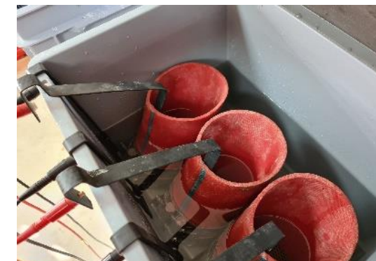
Fotografía: Probetas montadas en equipo para Migración de Cloruros.
