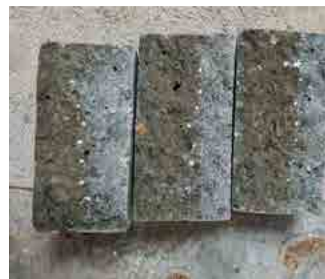
Fotografía: Probetas ensayadas para medición del coeficiente de migración de cloruros por NTBuild492. En gris claro se observa el frente de penetración de cloruros en el hormigón.
