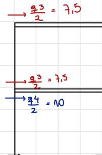
$$\vec{F} = \begin{pmatrix} \frac{q_4}{2} + \frac{q_3}{2} \\ \frac{q_3}{2} \end{pmatrix} = \begin{pmatrix} 17,5 \text{ tonf} \\ 7,5 \text{ tonf} \end{pmatrix}$$
