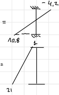
Por superposición el diagrama de Corte queda
